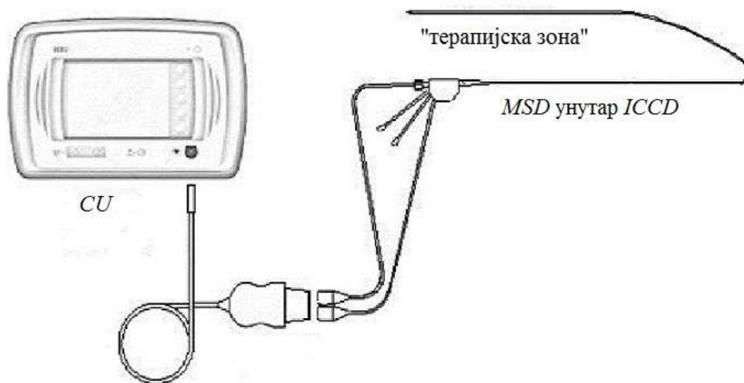
Слика 6. Шематски приказ EKOS ® уређаја; IDDC - Intelligent Drug Delivery Catheter , MSD - MicroSonic Device , CU - EkoSonic Control Unit ;
